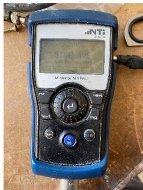
Pour tester un de ces appareils j'envoie un signal en entrée avec un générateur de signal et je vérifie les valeurs que j'obtiens à la sortie qui lui est associer (ex : pour l'entrée A1, la sortie est A).
