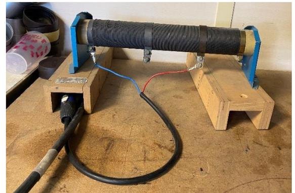
Figure 25/ Résistance de charge
