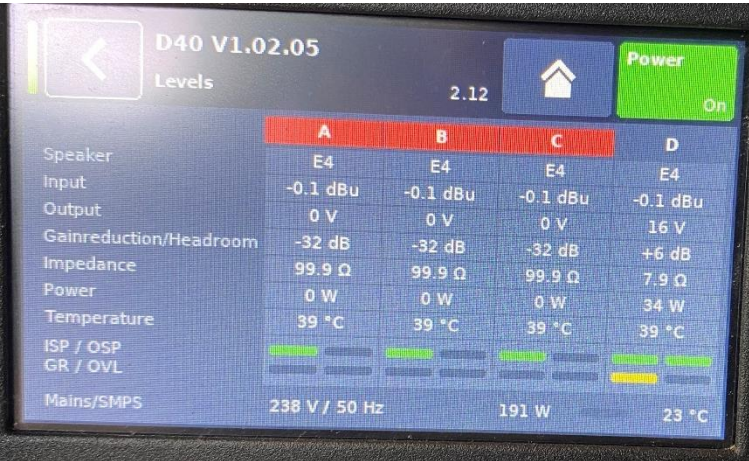
Figure 61/ Image de l'écran de la D40 n°1 (voie D dé-muté)
