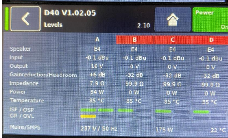
Figure 48// Image de l'écran de la D40 n°2 (voie A dé-muté)
