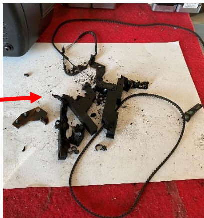
Figure 9/ Photo des morceaux endommagés du block Zoom&Focus
