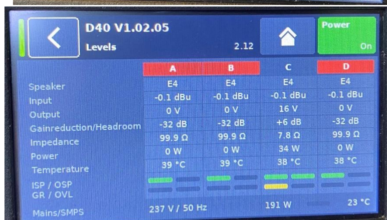
Figure 57/ Image de l'écran de la D40 n°1 (voie C dé-muté)
