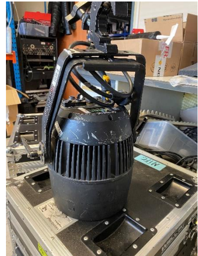
Figure 33/ Projecteur PAR LED RVBW 120HD
