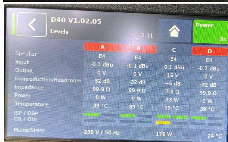
Figure 56/ Image de l'écran de la D40 n°2 (voie C dé-muté)
