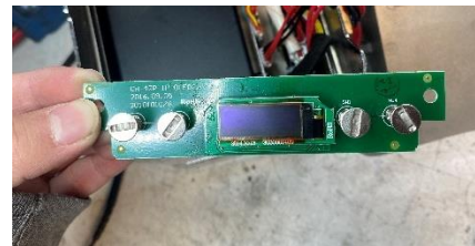
Figure 30/ Carte LCD & bouton de projecteur Led WELFIT 6-Pack ALU
