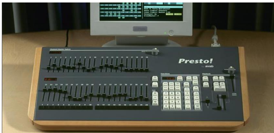
Figure 14/ Image d'une console PRESTO
