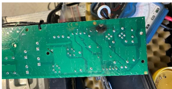
Figure 20/ Image de la carte électronique du projecteur P5 (vu sur la face présentant une brûlure)
