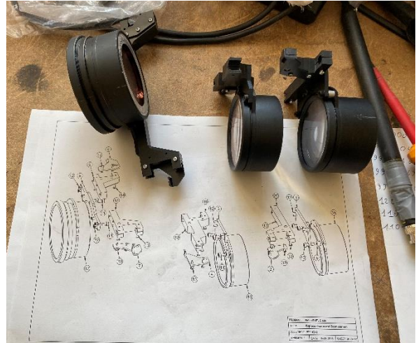
Figure 11/ Photo des trois lentilles récupérées sur le block Zoom& Focus dont les certaines des parties plastique ont cramé
