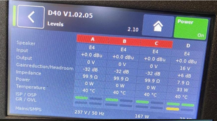
Figure 58/ Image de l'écran de la D40 n°7 (voie D dé-muté)
