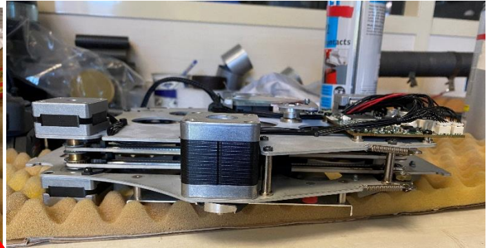
Figure 65/ Block filtres de Mac VIPER
