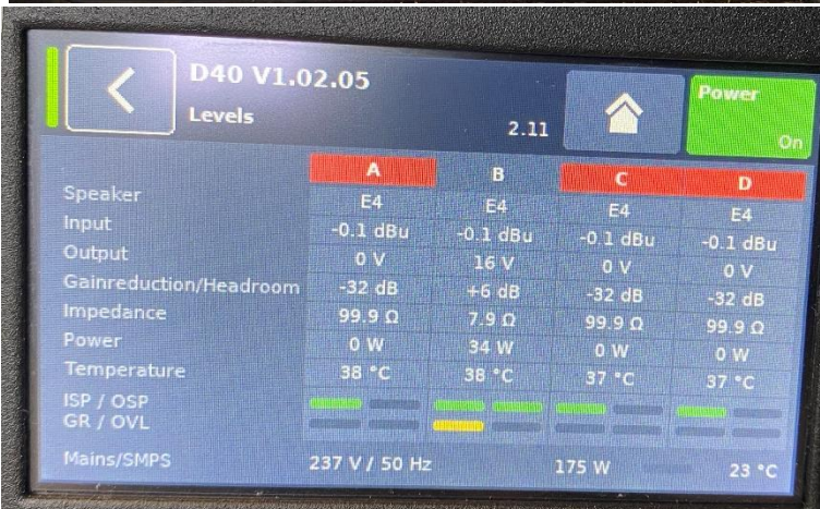
Figure 52/ Image de l'écran de la D40 n°2 (voie B dé-muté)
