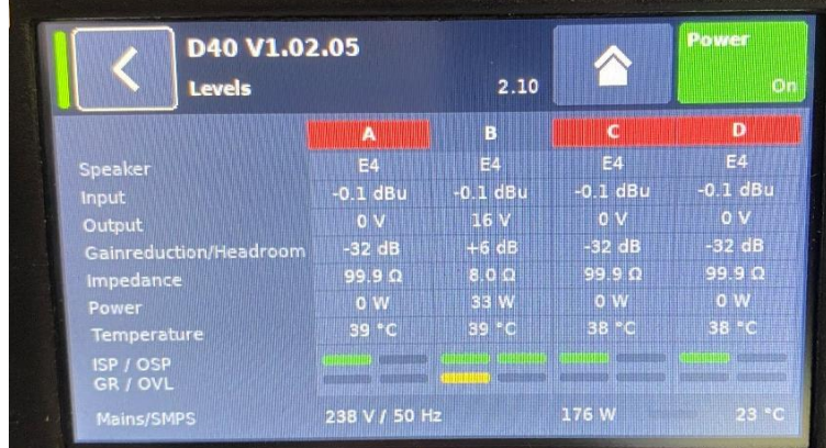
Figure 51/ Image de l'écran de la D40 n°3 (voie B dé-muté)
