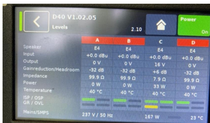
Figure 54/ Image de l'écran de la D40 n°7 (voie C dé-muté)
