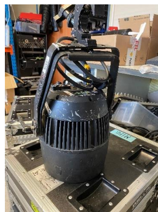
Figure 38/ Projecteur PAR LED RVBW 120HD
