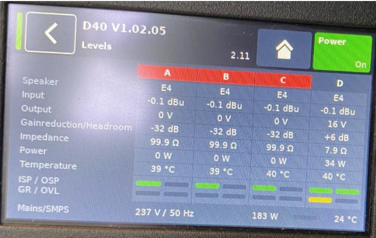
Figure 60/ Image de l'écran de la D40 n°2 (voie D dé-muté)
