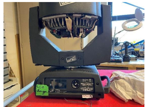
Figure 4/ Photo d'une LYRE partiellement ouvert
