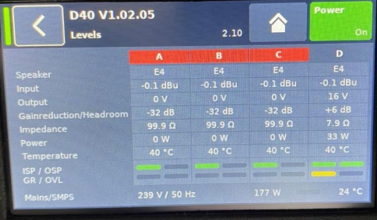
Figure 59/ Image de l'écran de la D40 n°3 (voie D dé-muté)
