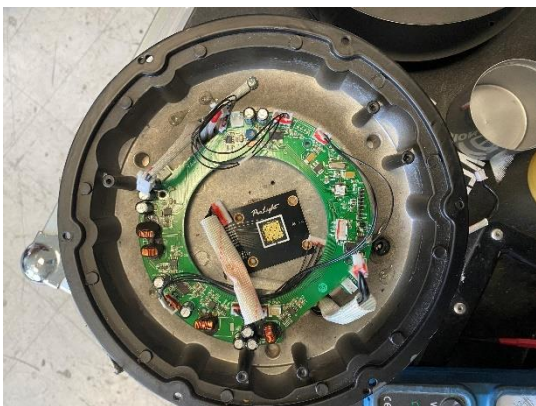
Figure 37/ Projecteur PAR LED RVBW 120HD (visuel sur la carte "driver led" et "led")
