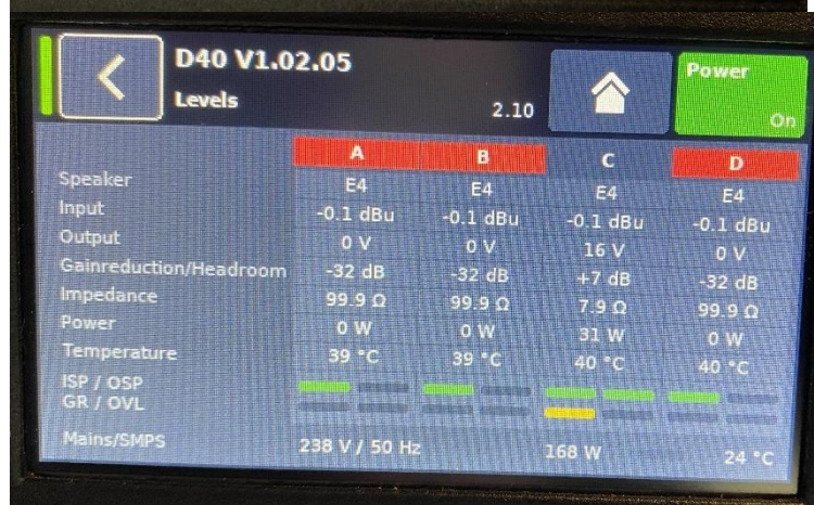
Figure 55/ Image de l'écran de la D40 n°3 (voie C dé-muté)
