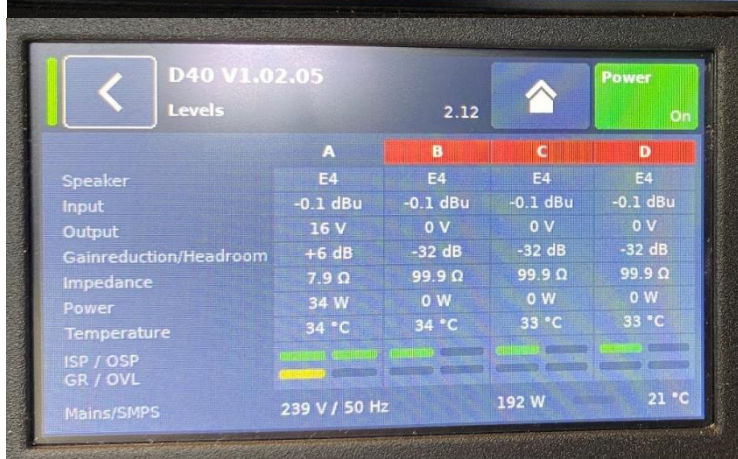
Figure 49// Image de l'écran de la D40 n°1 (voie A dé-muté)
