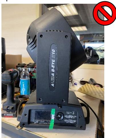
Figure 68/ Lyre K10 (mal positionner après la fin de la calibration auto)
