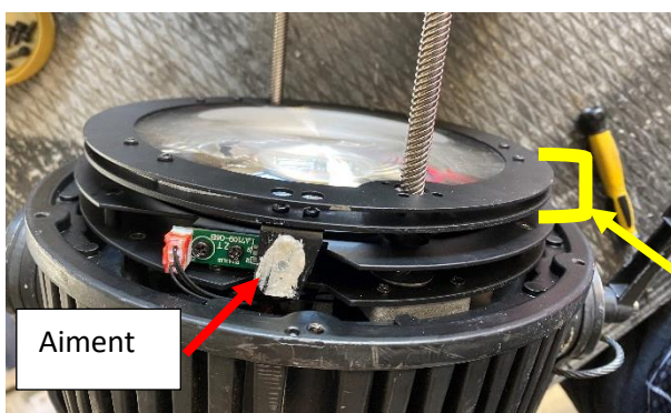
Figure 34/ Projecteur PAR LED RVBW 120HD (ouvert)
