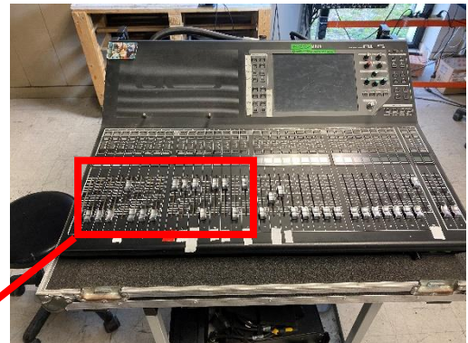
Figure 23/ Image d'une table de mixage QL5
