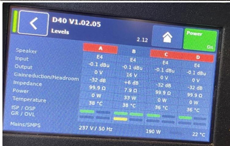
Figure 53/ Image de l'écran de la D40 n°1 (voie B dé-muté)
