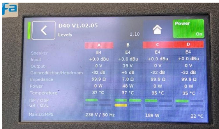
Figure 50 / Image de l'écran de la D40 n°7 (voie B dé-muté)
